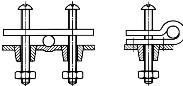
绝缘材料制造的器具部件且其形状明显地构成软线 夹紧构件之一被固定在器具上的结构示意图
