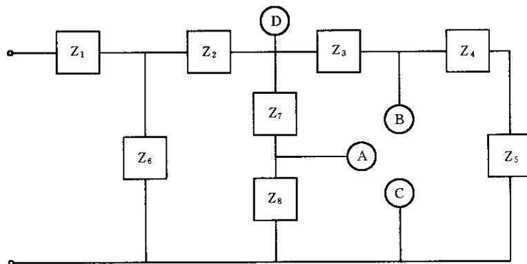
D是对外部负载提供最大功率超过 15 W 的距供电电源的最远点。
