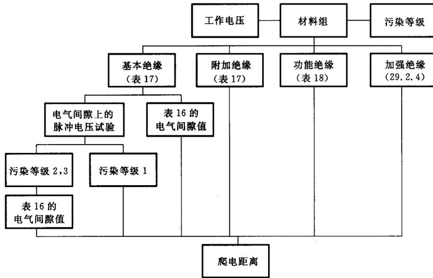
图 L.2 测定爬电距离的程序
