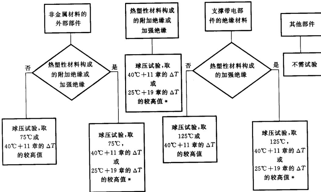
\* 如果 19.4 的试验由非自复位保护装置动作得到  $\Delta T$ , 该装置是由工具拆下或取下盖子以后才可复位, 则不考虑  $\Delta T$ 。
