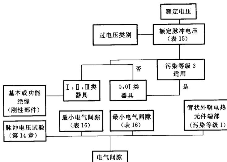
图 L.1 测定电气间隙的程序
